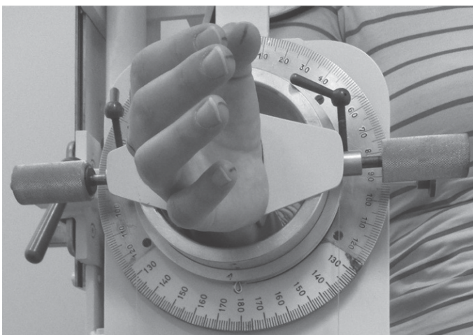
Abbildung 1: Messgerät für die passive Pronation (Foto: zzm)
